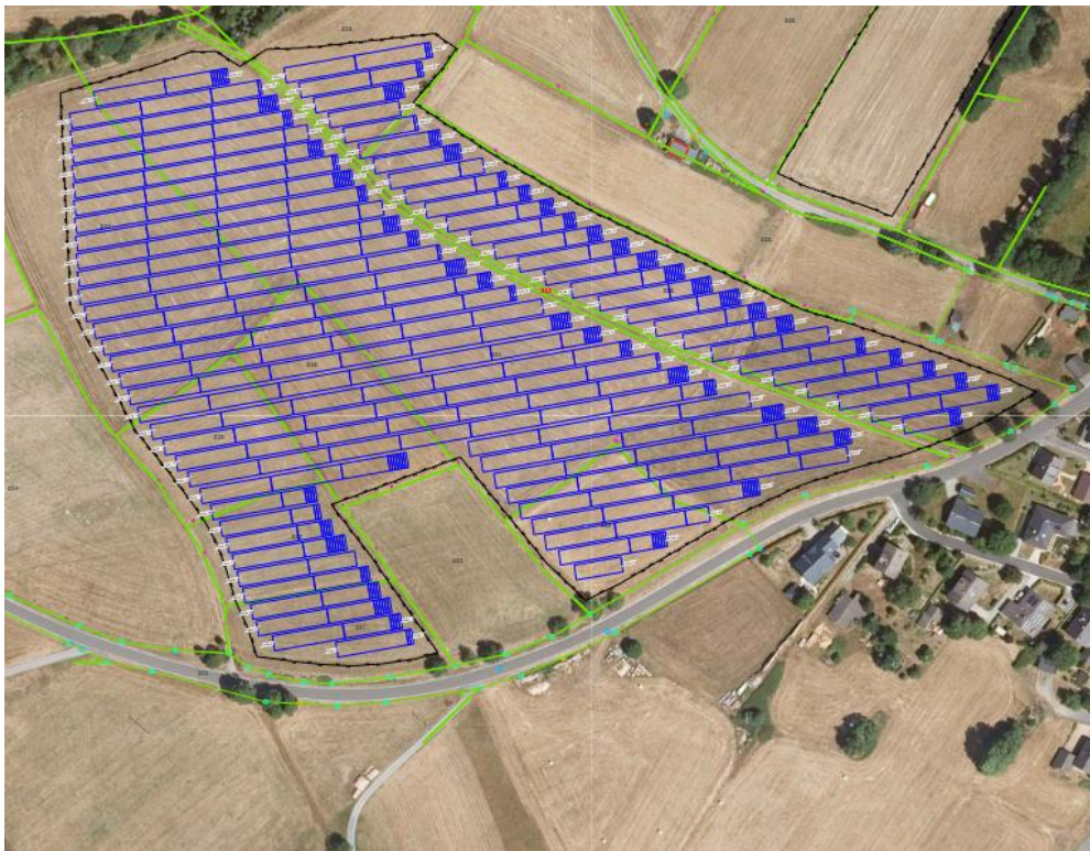
Abbildung 1: Übersicht der Anlagenfläche: Dargestellt sind die Modultische – Quelle Abbildung: Auftraggeber
